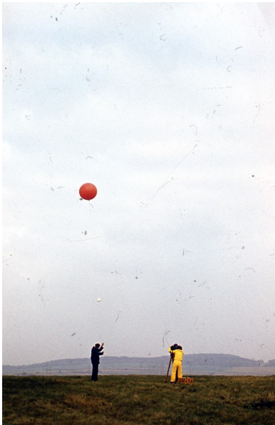
Scena sondowania meteorologicznego. Na otwartym polu dwie osoby, jedna w żółtym kombinezonie stoi przy teodolicie, a druga ciemnym ubraniu, wypuszcza balon meteorologiczny z radiosondą.
