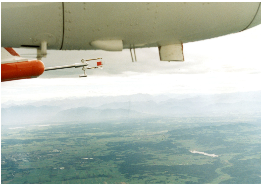
Kampania pomiarowa. Widać szybki termometr UFT na Dornierze 228 DLR w locie. Z kolekcji Instytutu Geofizyki FUW.
