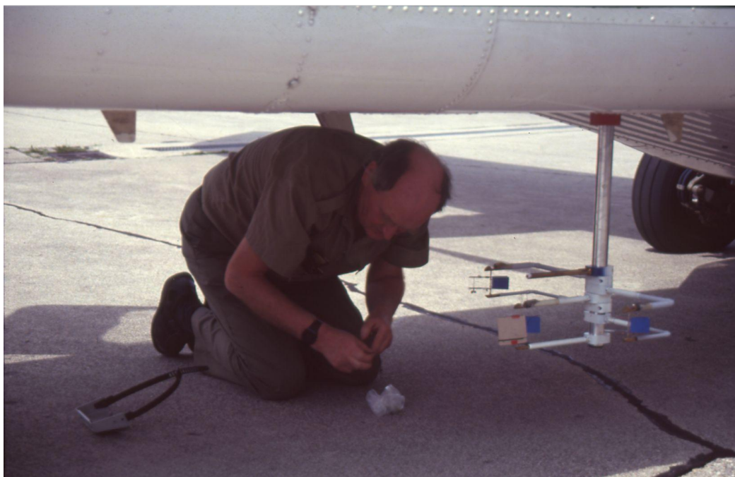
Kampania pomiarowa w Oberpfaffenhofen, 1999. Próby termometru na samolocie Falcon. Z kolekcji Instytutu Geofizyki FUW.
