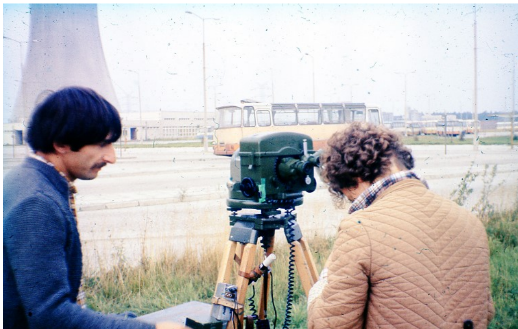
Małgorzata Nurek oraz Andrzej Makulski pracujący z teodolitem, używanym do pomiaru wiatru metodą pilotażu optycznego. W tle widoczna jest chłodnia kominowa i przemysłowe otoczenie, w tym parkujący autobus. Atmosfera zdjęcia jest typowa dla terenów przemysłowych z lat 70. lub 80. XX wieku.
